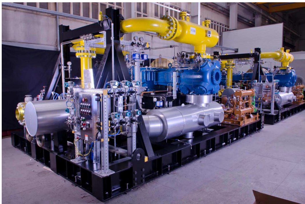
Рисунок 7 – НК «Роснефть», Новокуйбышевский НПЗ, КУ с двумя компрессорами Ариель JGT/2
