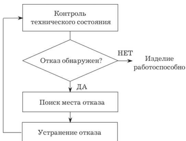
Рисунок 11 – Схема типового технологического процесса восстановления и непланового ремонта.
