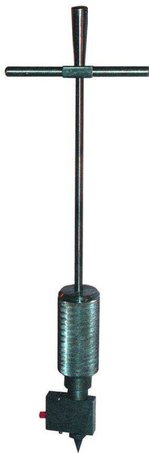
Рисунок 1.1 – Динамический плотномер-пенетромметр ДПА
