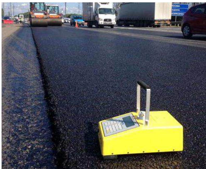
Рисунок 1.3 – Прибор радиометрического контроля уплотнения асфальтобетона
