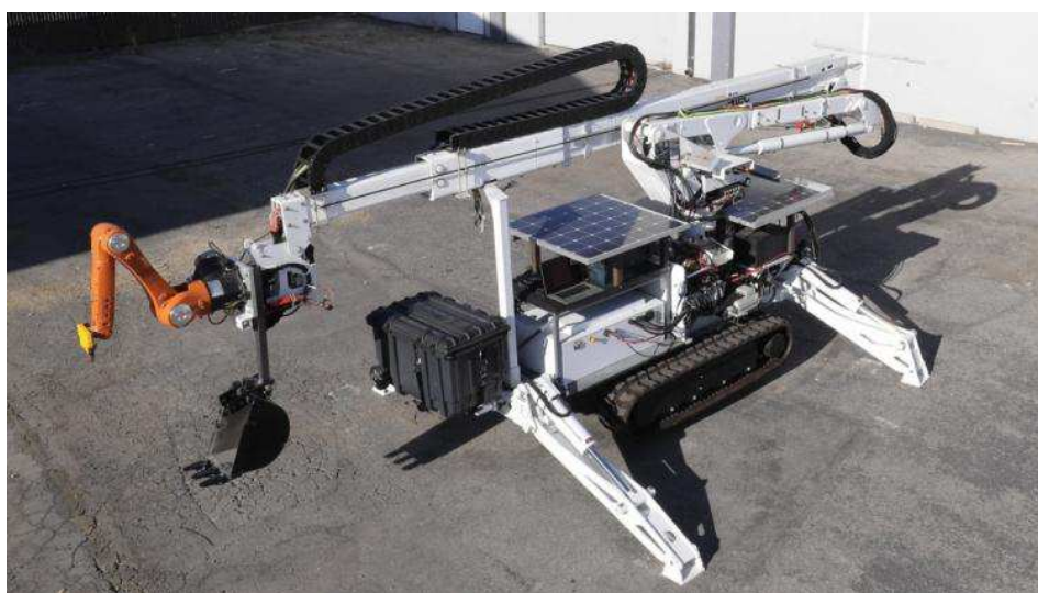
Рисунок 5 – Строительный манипулятор на гусеничном ходу
