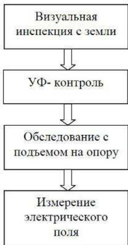
Рисунок 8 – схема контроля полимерной изоляции, используемая в Италии.
