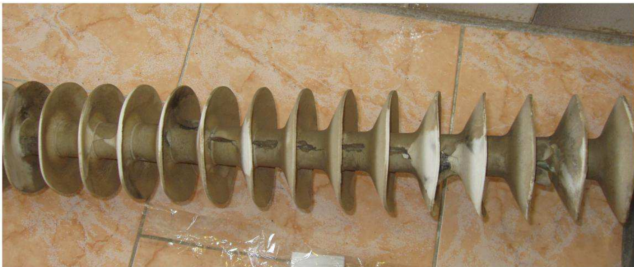
Рисунок 11 – Образование дендритов, треков на границе раздела, внутренняя эрозия защитной оболочки.
