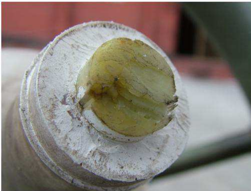
Рисунок 12 – Хрупкий излом изолятора.
