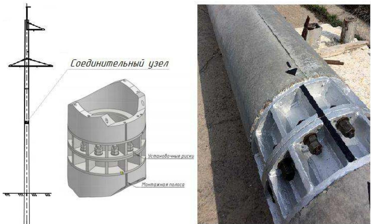
Рисунок 4 – Соединительный узел железобетонной стойки
