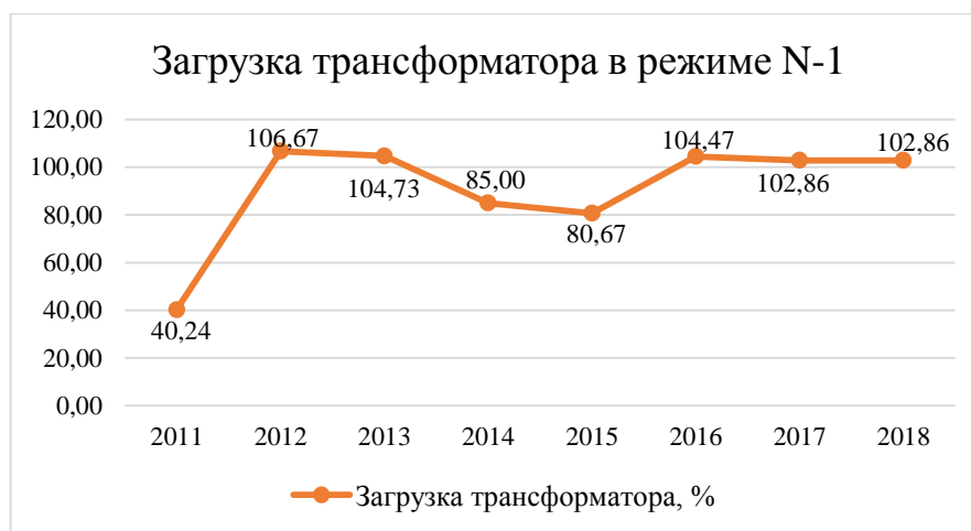
Рисунок 10 - Загрузка трансформатора в режиме N-1 на подстанции Северная 110кВ за 2011-2018 года
