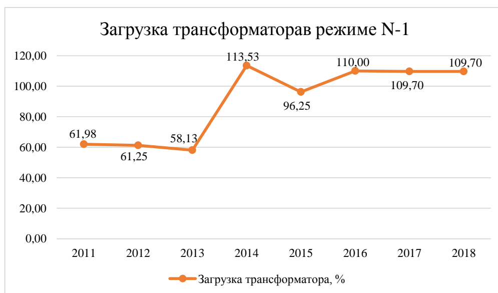
Рисунок 11 - Загрузка трансформатора в режиме N-1 на подстанции Аршаново 35кВ за 2011-2018 года
