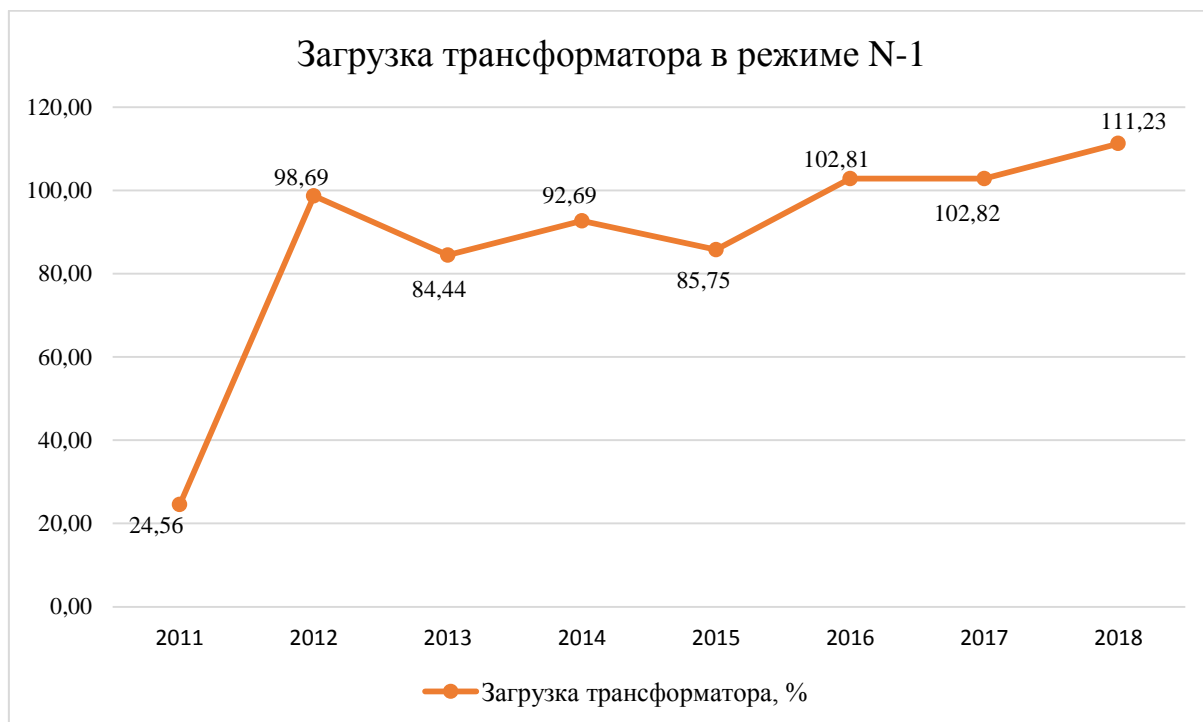
Рисунок 8 - Загрузка трансформатора в режиме N-1 на подстанции Юго-Западная 110кВ за 2011-2018 года
