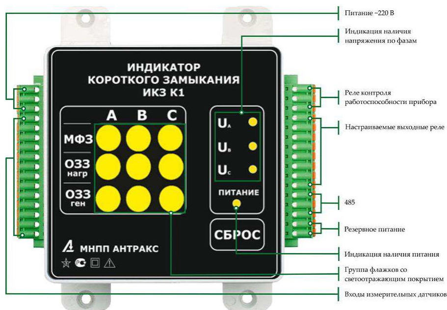
Рисунок 3.4 – Индикатор короткого замыкания для кабельных линий 6-35 кВ ИКЗ-К1
