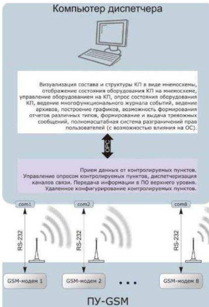
Рисунок 3.10 – Структура пункта управления GSM сигнализации
