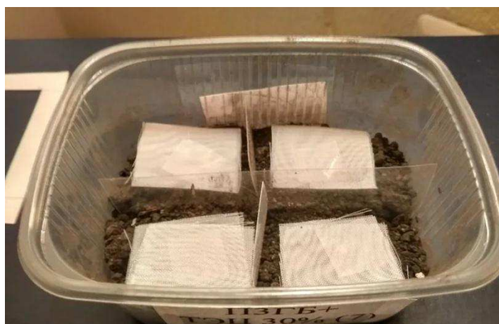
Рисунок 5 – Внешний вид контейнера с образцами (в чехлах из органзы)
