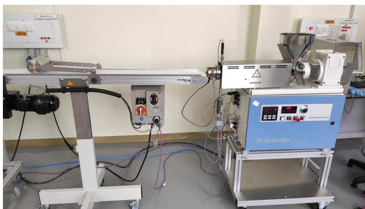
Рисунок 6 – одношнековый экструдер Brabender Kompaktextruder KE19 с линией транспортера
