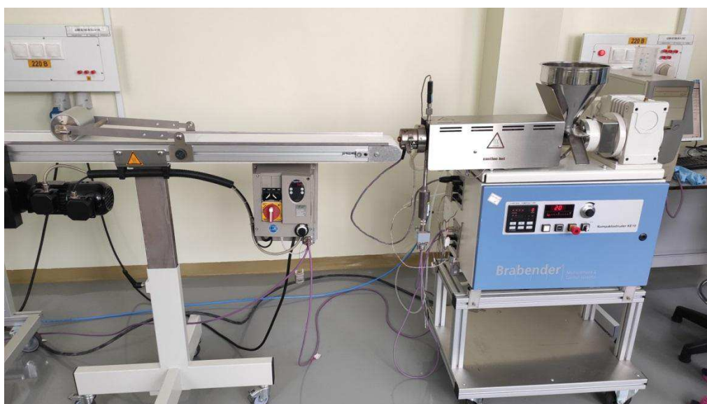
Рисунок 9 – Одношнековый экструдер Brabender Kompaktextruder KE19 с линией транспортера
