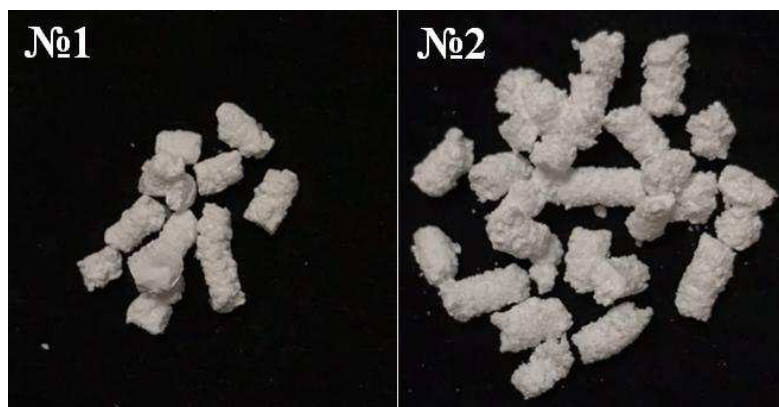
Рисунок 8 – Гранулы, полученные методом влажного гранулирования: №1 – П(ЗГБ), №2 – П(ЗГБ) + 15 % триацетина
