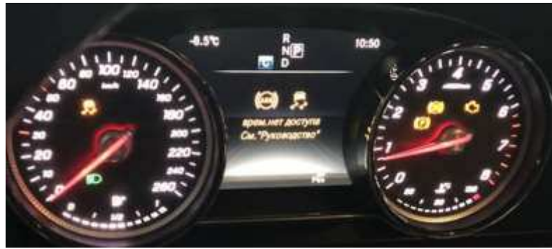
Рисунок 2.17 – Ошибка в датчиках тормозной системы
