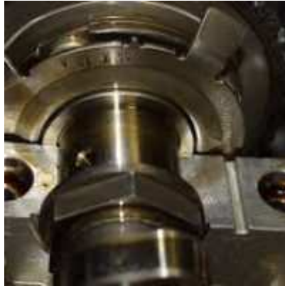
Рисунок 2.4 – Смещение импульсного диска
