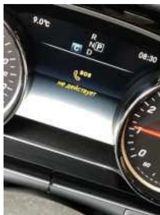
Рисунок 2.21 – Ошибка «SOS» при выходе антенны GPS из строя
