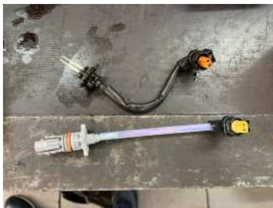
Рисунок 2.12 – Замена старого провода на новый
