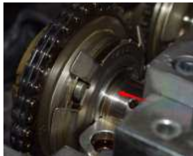
Рисунок 2.5 – Износ металла шейки распредвала
