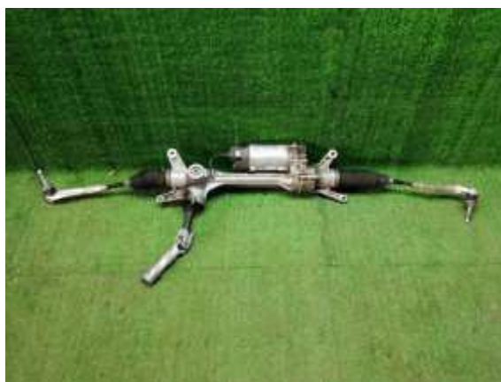
Рисунок 2.9 – Рулевая рейка Mercedes
