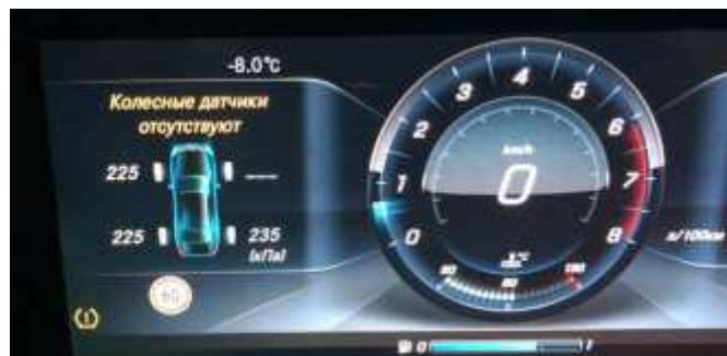
Рисунок 2.18 – ошибка колесных датчиков
