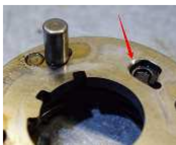
Рисунок 2.3 – Внутренний износ фазорегулятора ГРМ
