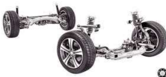
Рисунок 2.10 – Подвеска Mercedes W213
