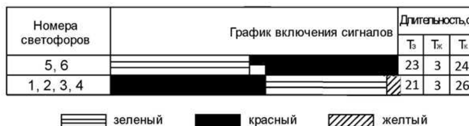
Рисунок 2.15 – График работы светофорной сигнализации на УДС пр. д. 15 – д. 25
