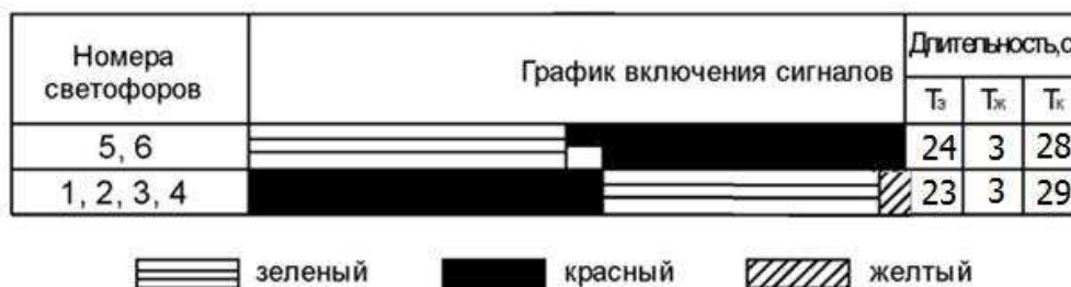
Рисунок 2.21 – График работы светофорной сигнализации на УДС пр. Мира – ул. Федотова
