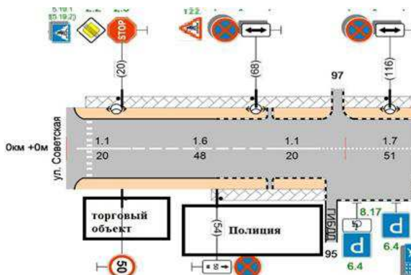
Рисунок 2.3 – Схема проектируемой ОДД на участке г. Заозерный по ул.Мираведущую на ул. Советскую.
