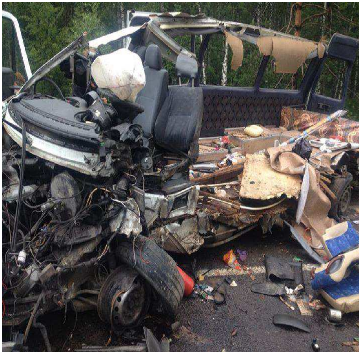
Рисунок 3.1 – Пример встречного столкновения при неупругом ударе
