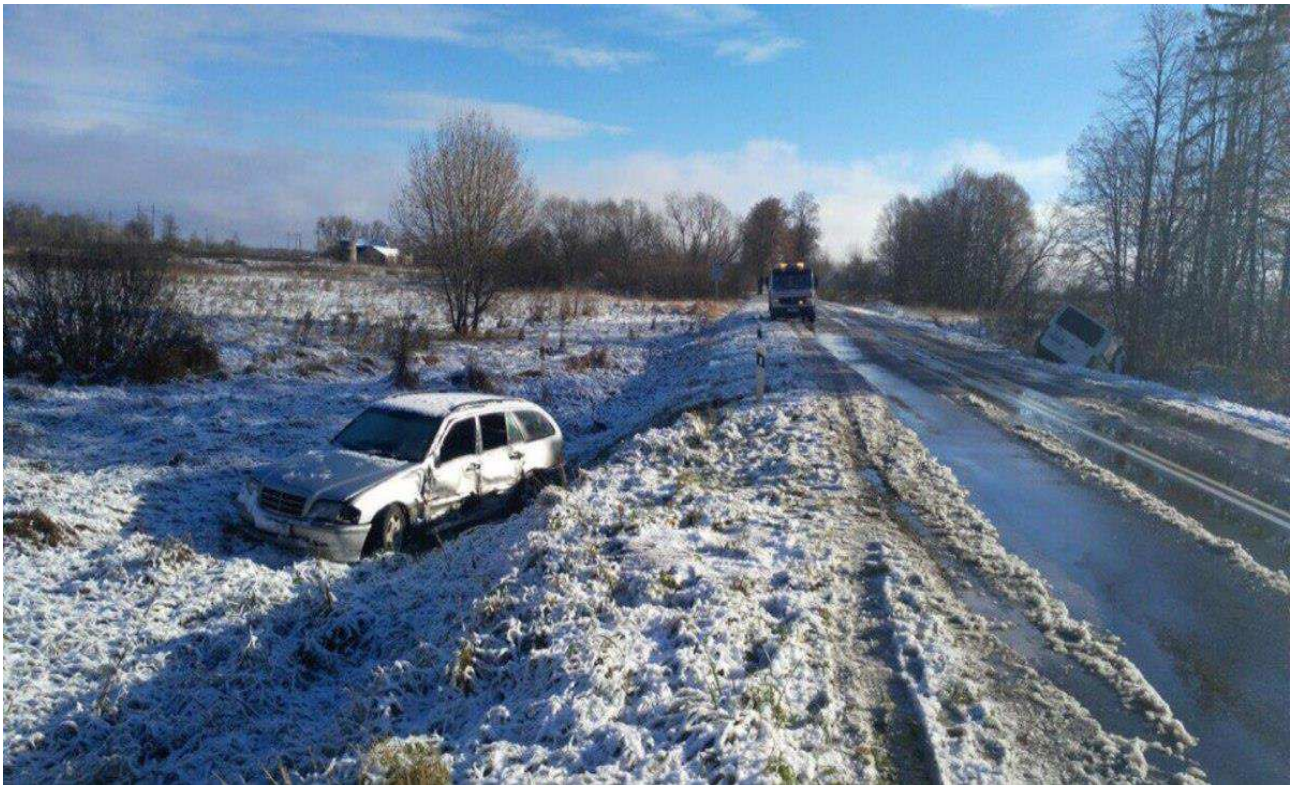
Рисунок 3.2 – Пример столкновения связанный с большим разлетом ТС после удара
