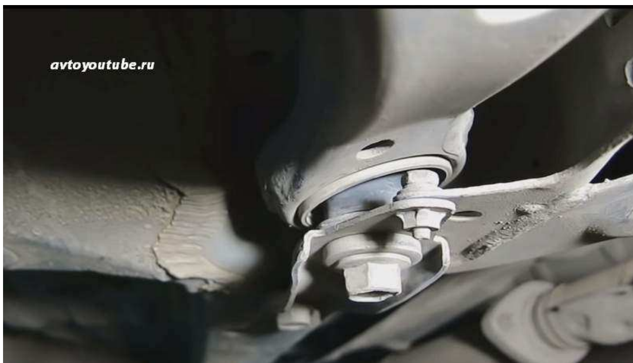
Рисунок 1.11 – Метод диагностики сайлентблоков и втулок
