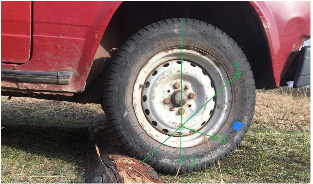
Рисунок 2.2 – Силы, действующие на автомобиль при съезде с искусственной неровности
