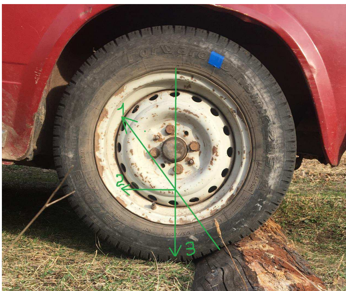
Рисунок 2.1 – Силы, действующие на автомобиль при наезде на искусственную неровность
