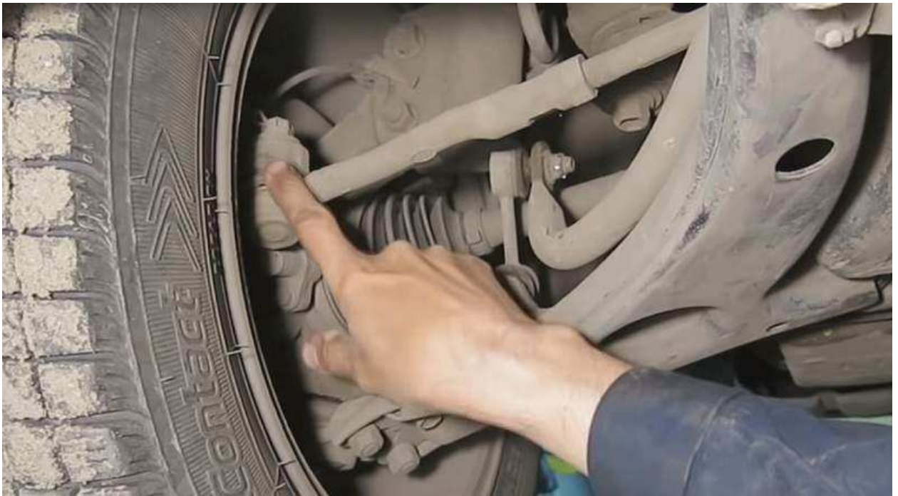
Рисунок 1.9 – Диагностика рулевого наконечника
