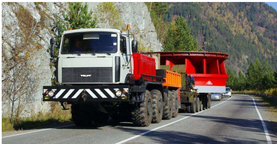
Рисунок 1.19 - Вид МЗКТ-741320 с прицепом-тралом в процессе доставки рабочего колеса гидротурбины СШГЭС.
