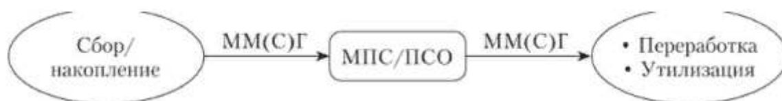
Рис. 1.8. Схема двухэтапной системы транспортирования ТБО: ММ(С)Г — мусоровозы малой/средней грузоподъемности; МБГ — мусоровозы большой грузоподъемности; МПС — мусороперегрузочные станции; ПСО — пункты сбора отходов
