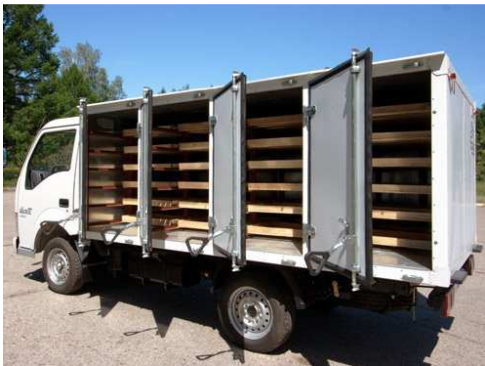
Рисунок 1.4 – Автомобиль, загруженный лотками для перевозки хлебобулочных изделий
