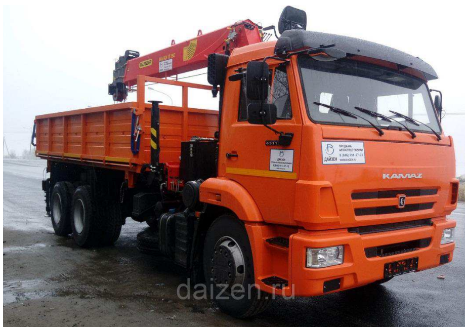
Рисунок 51 – Внешний вид автомобиля КамАЗ-65115, оборудованного КМУ ИМ-150Т
