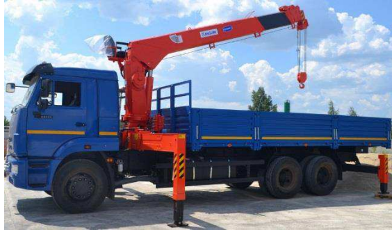
Рисунок 43 – Автомобиль-самопогрузчик: а) – с портальной стрелой; б) – с консольной стрелой
