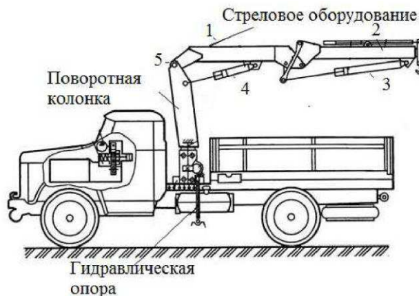
Рисунок 45 – Схема автомобиля-самопогрузчика с консольной гидравлической установкой
