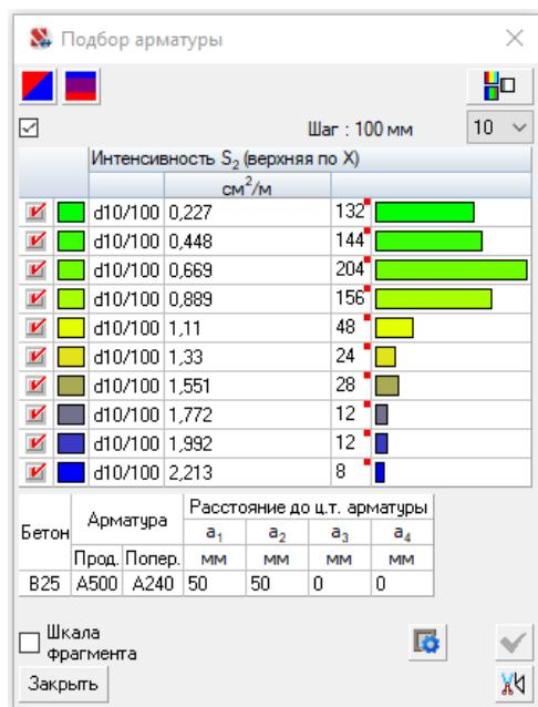
Рисунок 2.2.9 - Диаметры верхней арматуры по оси Х при шаге 100 мм
