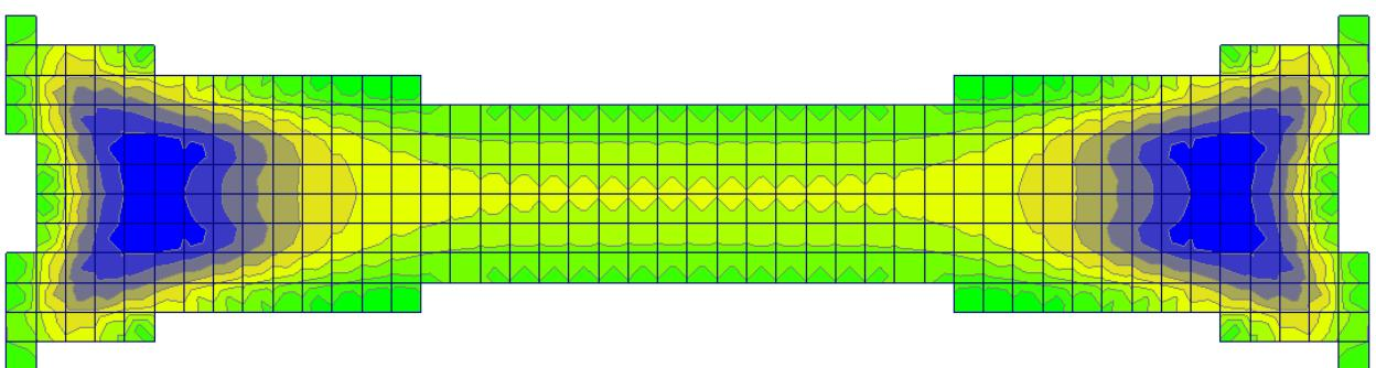
Рисунок 2.2.4 - Диаметры нижней арматуры по оси Х при шаге 100 мм
