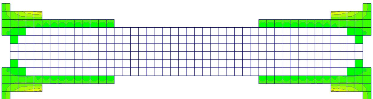
Рисунок 2.2.10 - Диаметры верхней арматуры по оси У при шаге 100 мм
