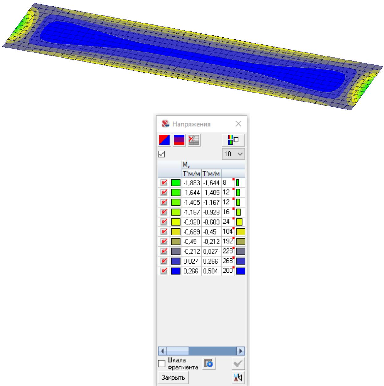
Рисунок 2.2.2 – Поля распределения напряжений  $M_x$  в плите ((кН·м)/м)
