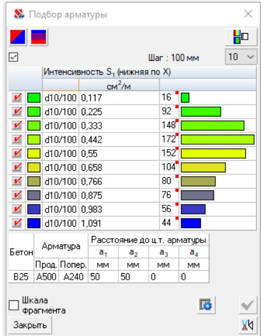
Рисунок 2.2.5 - Диаметры нижней арматуры по оси Х при шаге 100 мм
