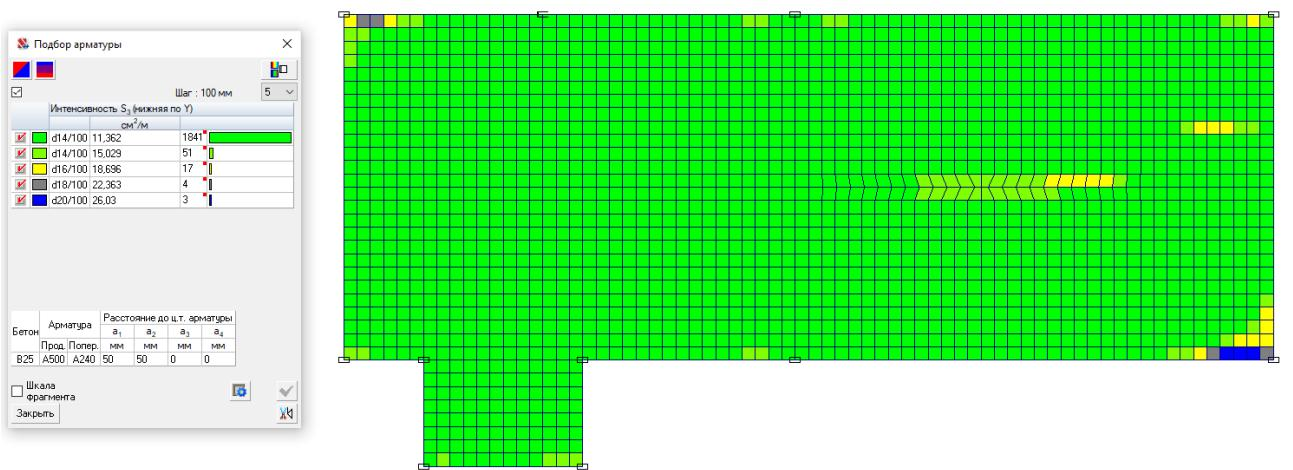
Рисунок 3.2.5 - Диаметры нижней арматуры по оси Y при шаге 100 мм
