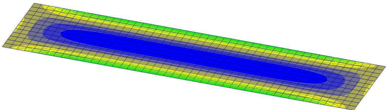
Рисунок 2.2.3 – Поля распределения напряжений  $M_y$  в плите ((кН·м)/м)
