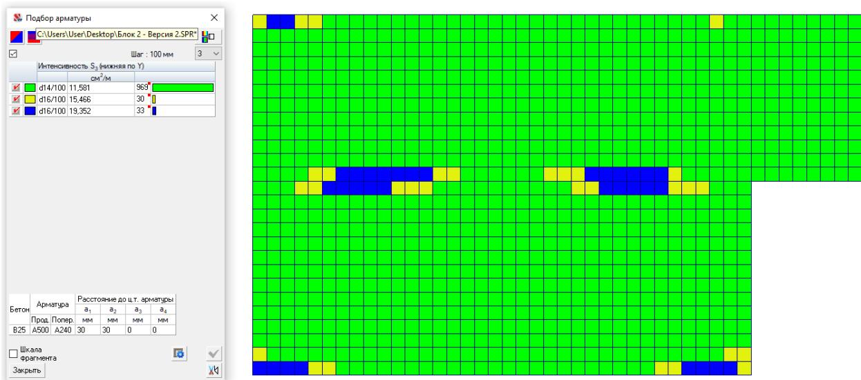
Рисунок 3.2.13 - Диаметры нижней арматуры по оси У при шаге 100 мм
