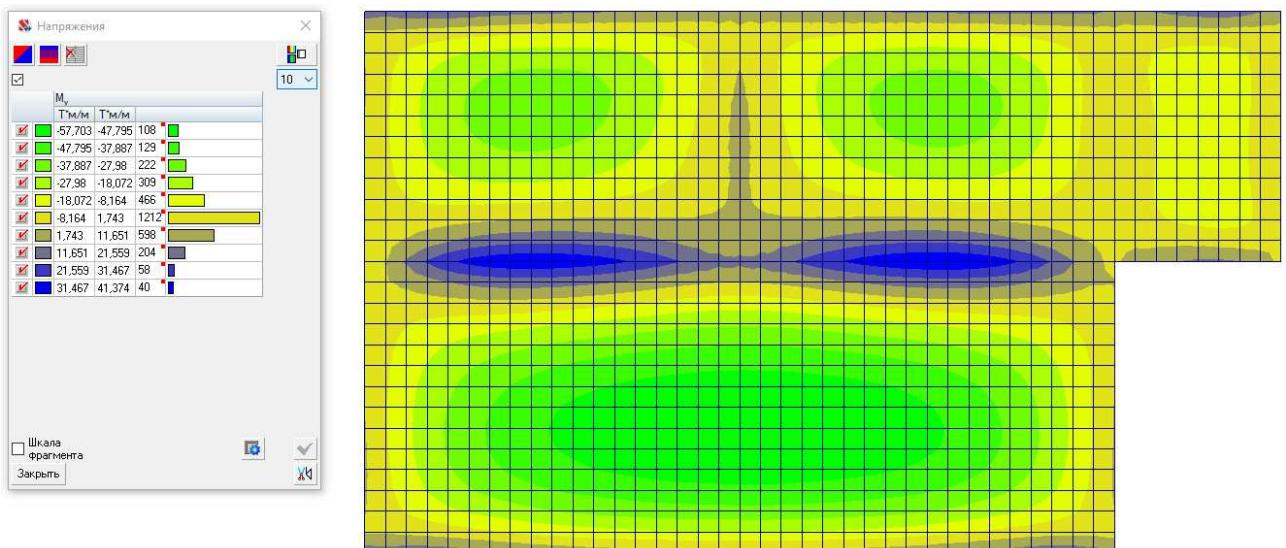
Рисунок 3.2.11 – Поля распределения напряжений  $M_y$  в плите ((кН·м)/м)
