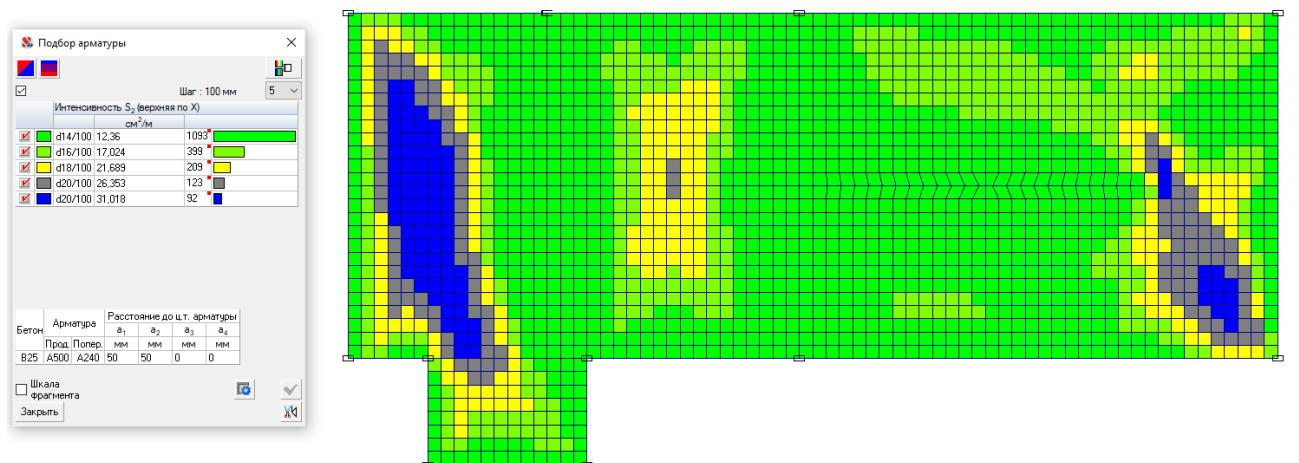
Рисунок 3.2.6 - Диаметры верхней арматуры по оси X при шаге 100 мм
