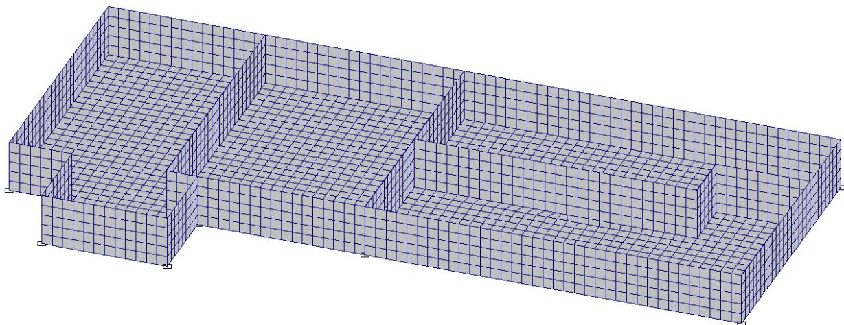
Рисунок 3.2.1 – Расчетная схема плиты
