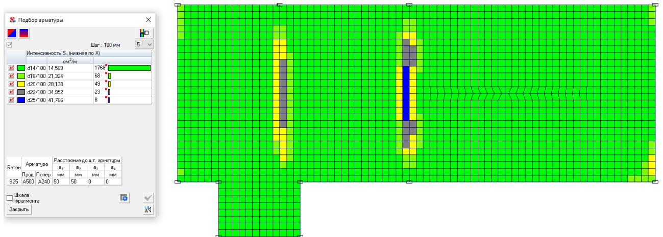
Рисунок 3.2.4 - Диаметры нижней арматуры по оси X при шаге 100 мм
