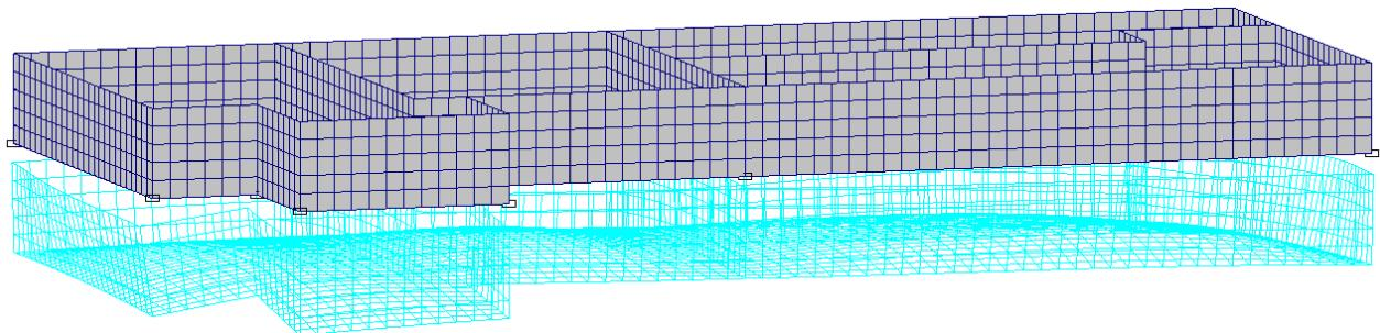
Рисунок 3.2.8 - Вертикальные деформации перекрытия при действии расчетных нагрузок, мм
