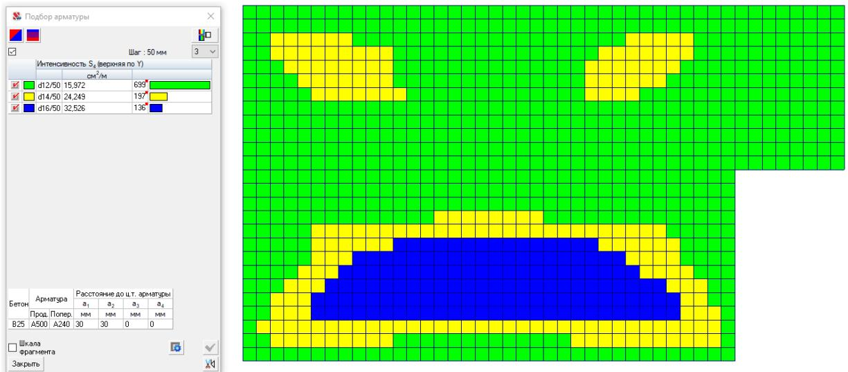
Рисунок 3.2.15 - Диаметры верхней арматуры по оси У при шаге 50 мм
