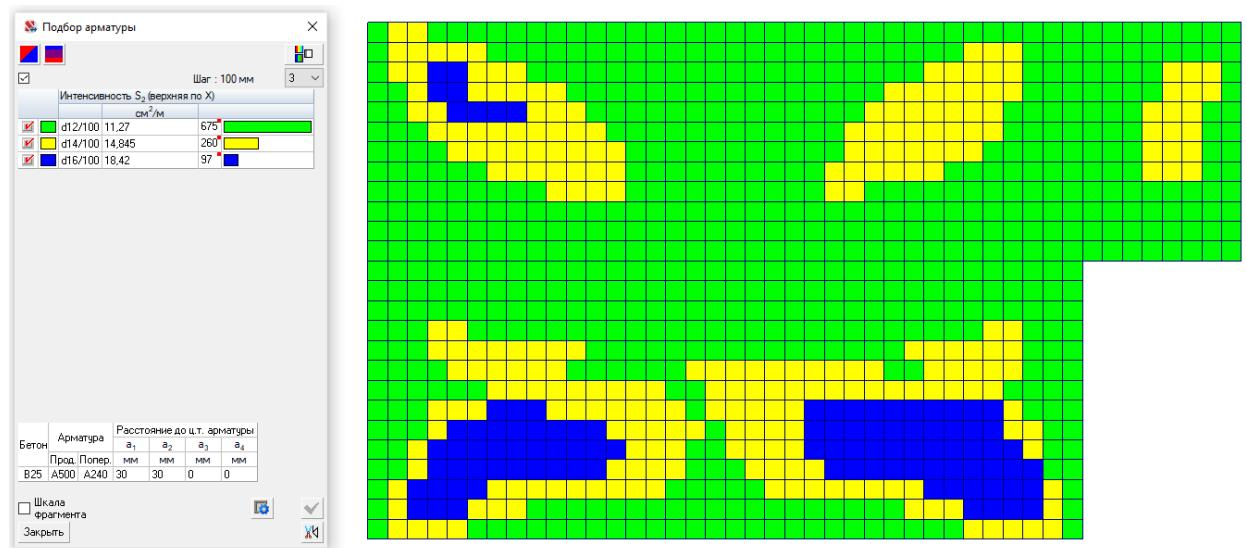
Рисунок 3.2.14 - Диаметры верхней арматуры по оси Х при шаге 100 мм
