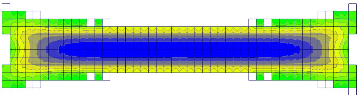
Рисунок 2.2.6 - Диаметры нижней арматуры по оси У при шаге 100 мм
