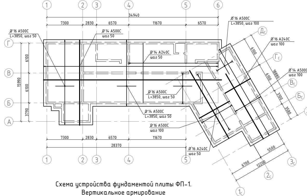
Схема устройства фундаментной плиты ФП-1.
