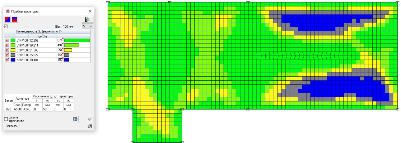
Рисунок 3.2.7 - Диаметры верхней арматуры по оси У при шаге 100 мм
