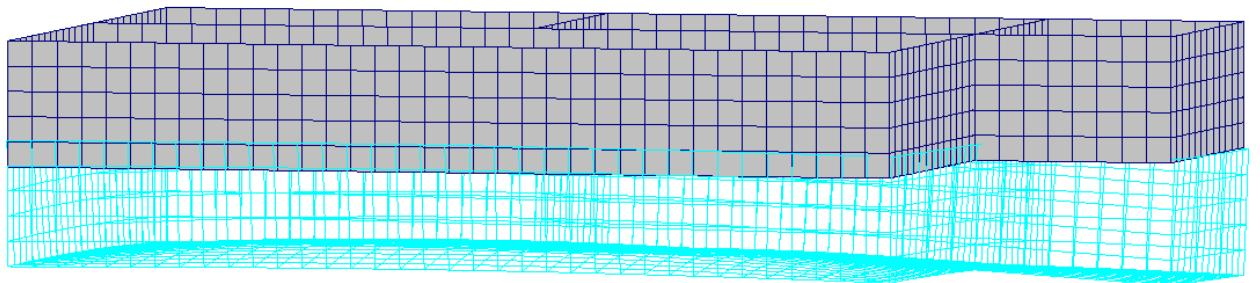
Рисунок 3.2.16 - Вертикальные деформации перекрытия при действии расчетных нагрузок, мм
