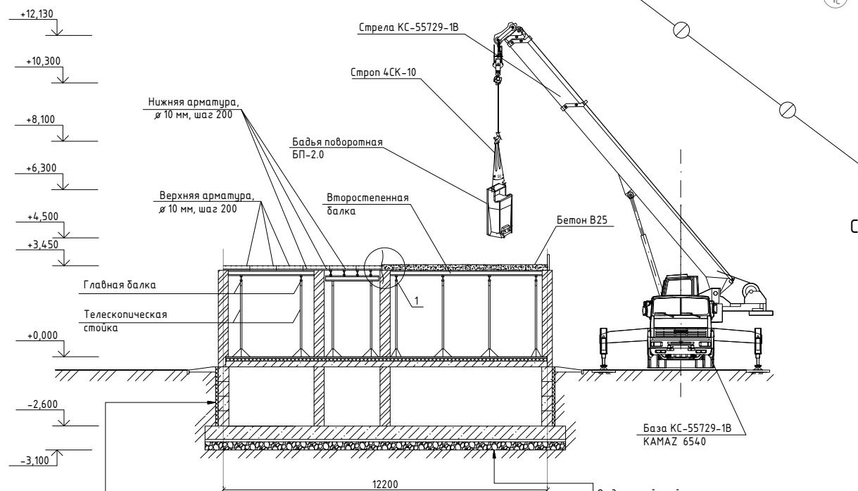
Характеристики крана КС-55729-1В на базе КАМАЗ 6540:
