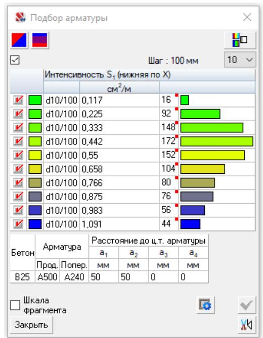
Рисунок 2.2.7 - Диаметры нижней арматуры по оси У при шаге 100 мм
