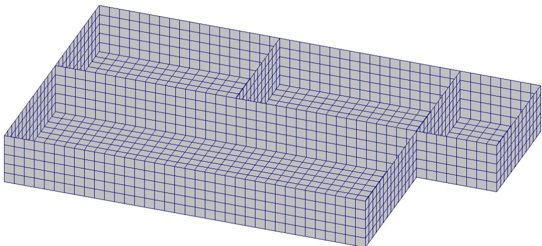
Рисунок 3.2.9 – Расчетная схема плиты
