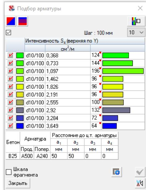
Рисунок 2.2.11 - Диаметры верхней арматуры по оси У при шаге 100 мм
