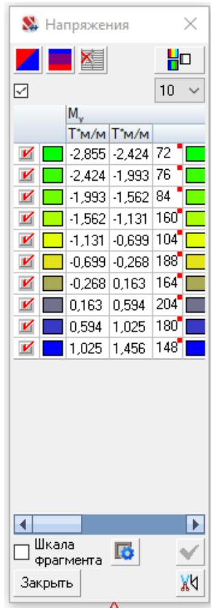
Рисунок 2.2.3 – Поля распределения напряжений  $M_y$  в плите ((кН·м)/м)
