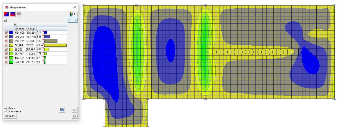
Рисунок 3.2.2 – Поля распределения напряжений  $M_x$  в плите ((кН·м)/м)
