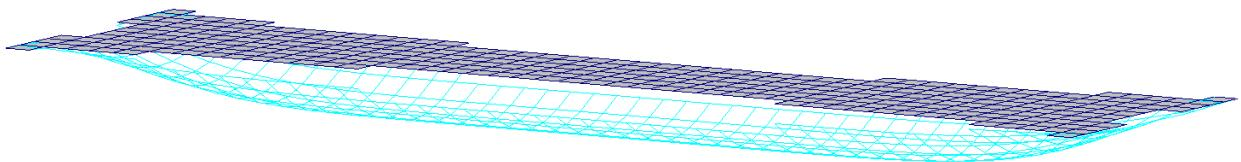
Рисунок 2.2.7 - Вертикальные деформации перекрытия при действии расчетных нагрузок, мм
