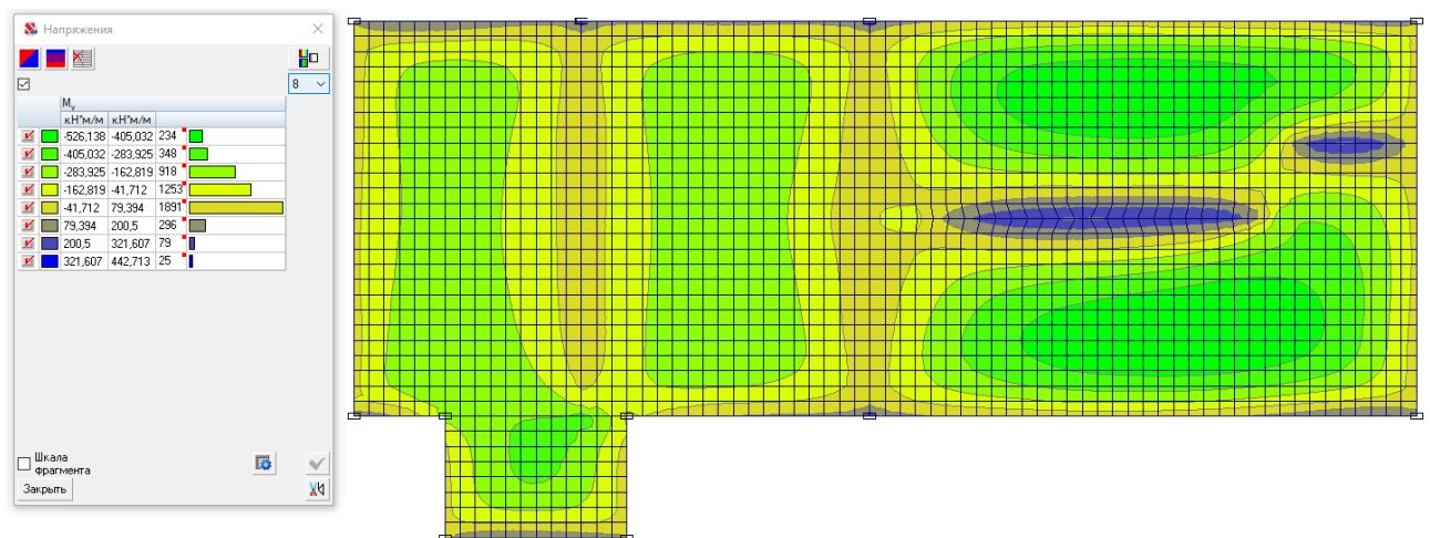
Рисунок 3.2.3 – Поля распределения напряжений  $M_y$  в плите ((кН·м)/м)
