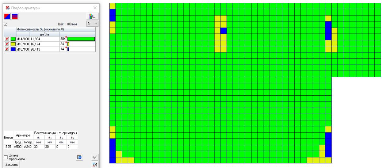
Рисунок 3.2.12 - Диаметры нижней арматуры по оси Х при шаге 100 мм
