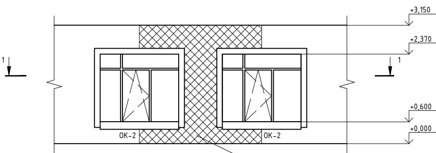
Фрагмент плана расчетного простенка в осях 4-5/Б
