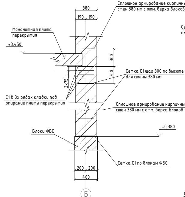
Принципиальная схема армирования кирпичной кладки
