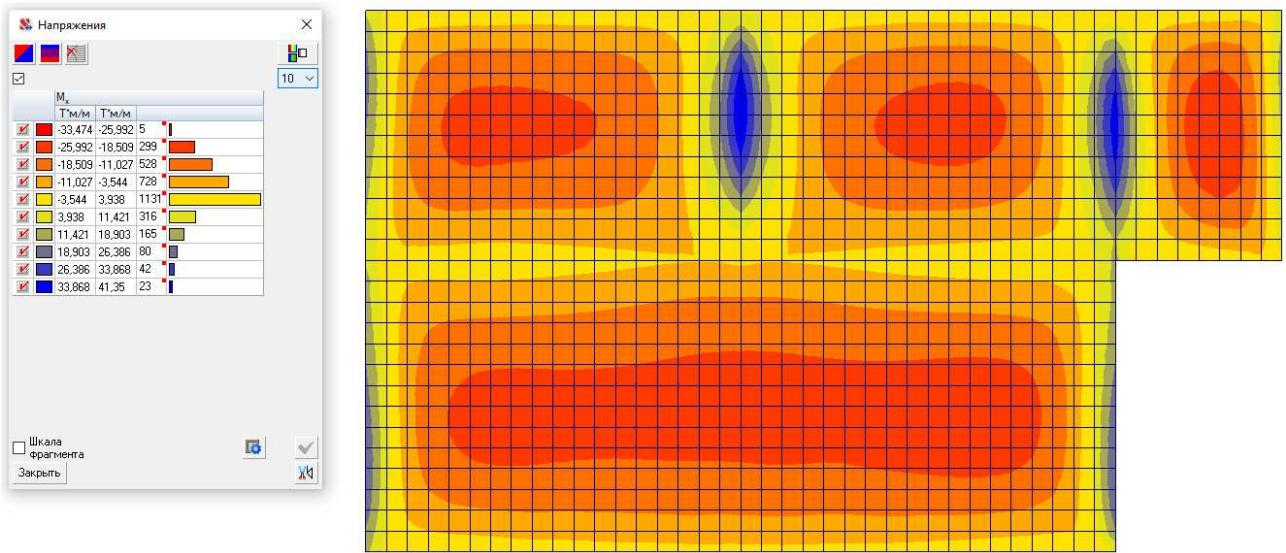
Рисунок 3.2.10 – Поля распределения напряжений  $M_x$  в плите ((кН·м)/м)
