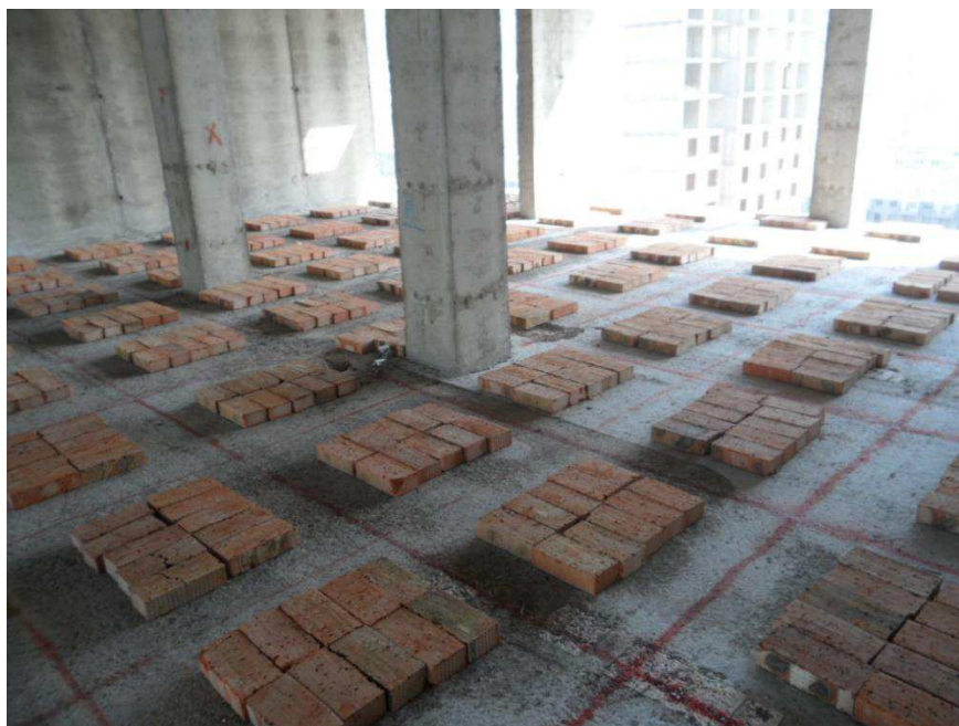
Рисунок 3.9 - Раскладка нагрузки от кирпичей (этап 1 – 32 кг/м 2 )
