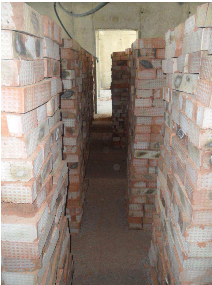
Рисунок 3.10 - Раскладка нагрузки от кирпичей (этап 22 – 736 кг/м 2 )
