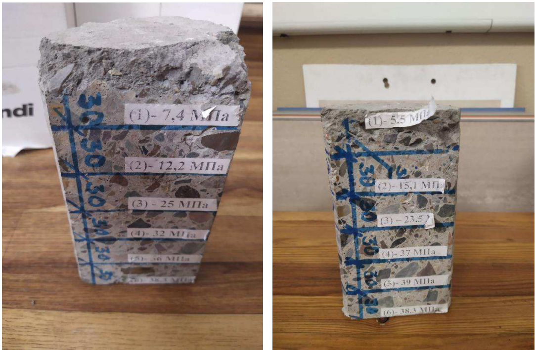
Рисунок 3.3 - Испытание образца из плиты, выполненной с нарушениями требований зимнего бетонирования
