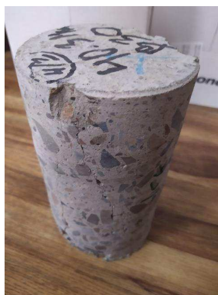
Рисунок 3.2 - Испытание образца из плиты, выполненной без нарушений требований зимнего бетонирования
