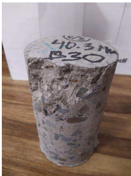
Рисунок 3.2 - Испытание образца из плиты, выполненной без нарушений требований зимнего бетонирования
