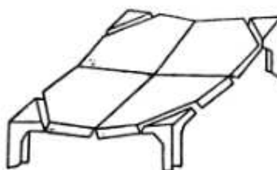
Рисунок 1.12 -Характер разрушения безбалочных плит опертых на колонны с капителями
