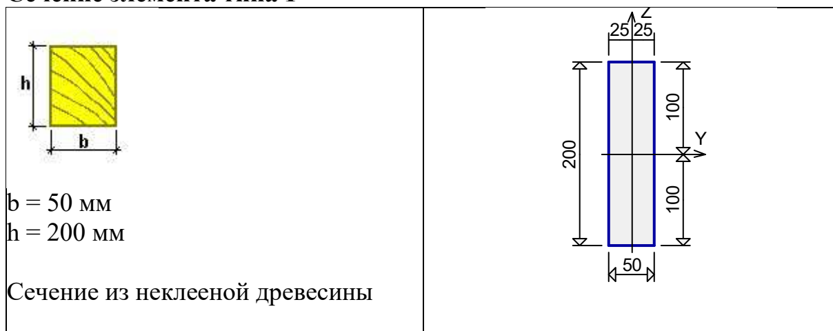
Рисунок Б.2 – Поперечное сечение стропильной ноги
