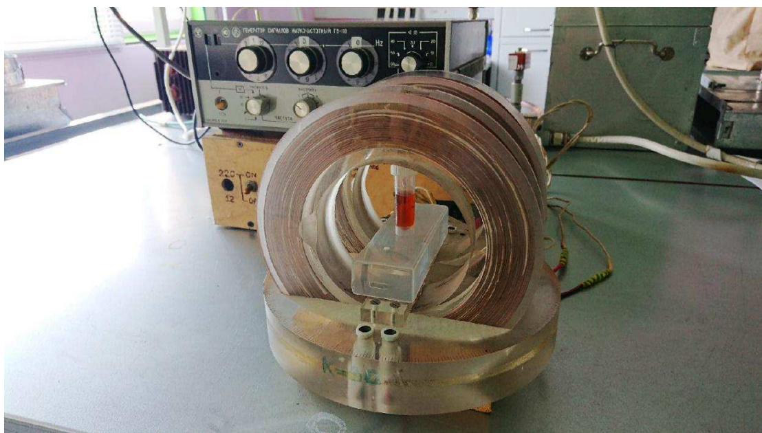
Рисунок 9 – установка генерации переменного магнитного поля
