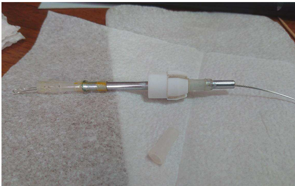
Рисунок 7 – устройство для удержания образца в активной зоне ЭПР спектрометра
