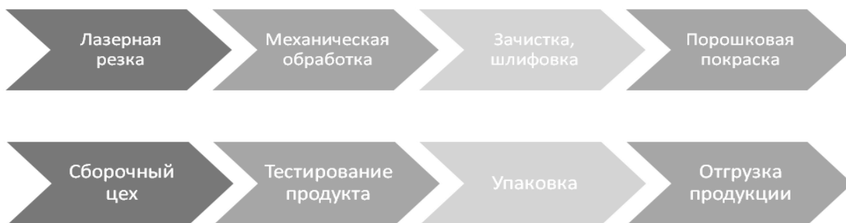
Рисунок 2.8 – Процесс производства продукции АО «ОКБ АРТ/ Ledvizor»
