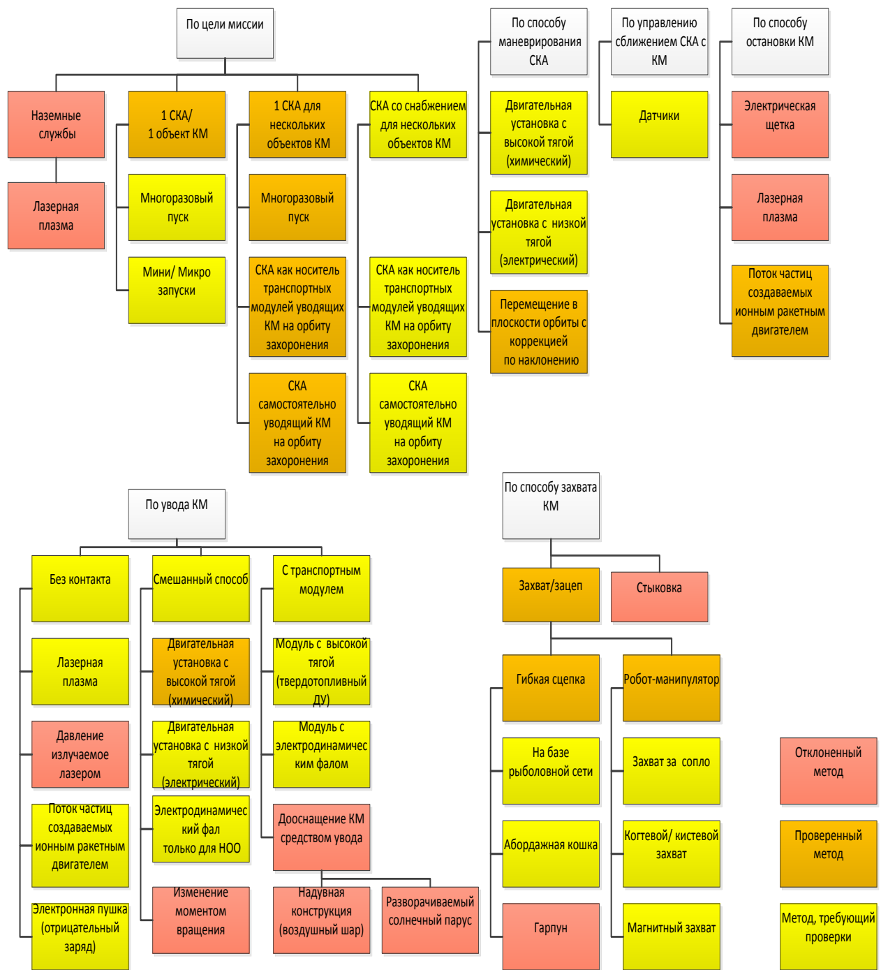
Рисунок 2 – Блок-схема существующих и перспективных технологий очистки орбит от объектов КМ (по материалам CNES)
