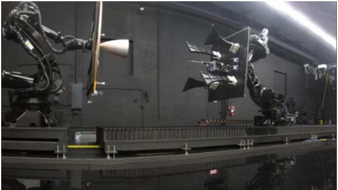
Рисунок 8 – Симулятор маневра стыковки КА MEV (справа) с обслуживаемым КА
