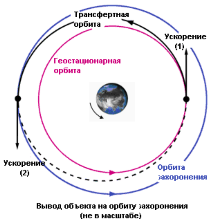
Рисунок 1 – Условная схема вывода КА на орбиту захоронения
