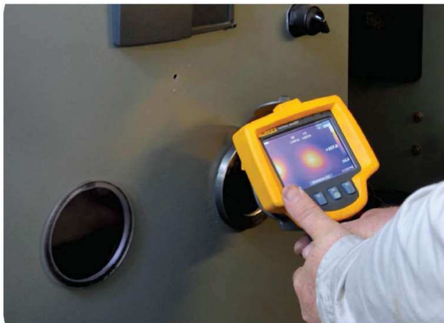
Рисунок 19 – Диагностика через окно в дверце распределительного устройства
