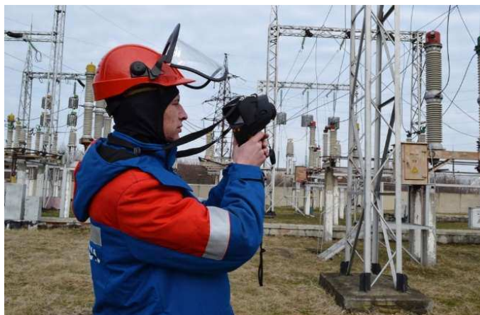
Рисунок 25 – Диагностика с помощью тепловизора Testo 875-2i
