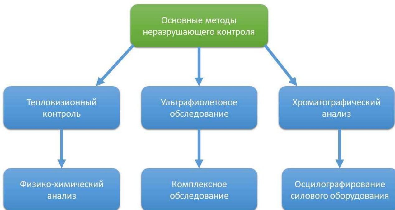
Рисунок 17 – Основные методы неразрушающего контроля
