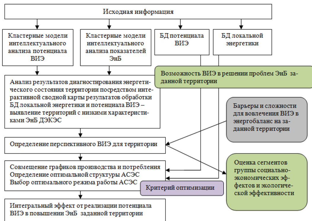
Рис. 1. Алгоритм выбора оптимальной структуры ДЭКЭС для децентрализованной зоны Севера и Арктических зон
