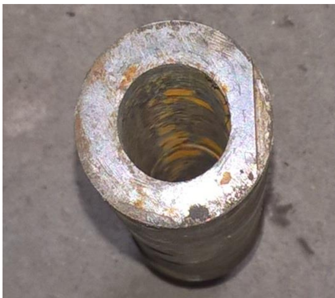
Рис.5. Модифицированный ударник для нанесения внецентренного ударного импульса
