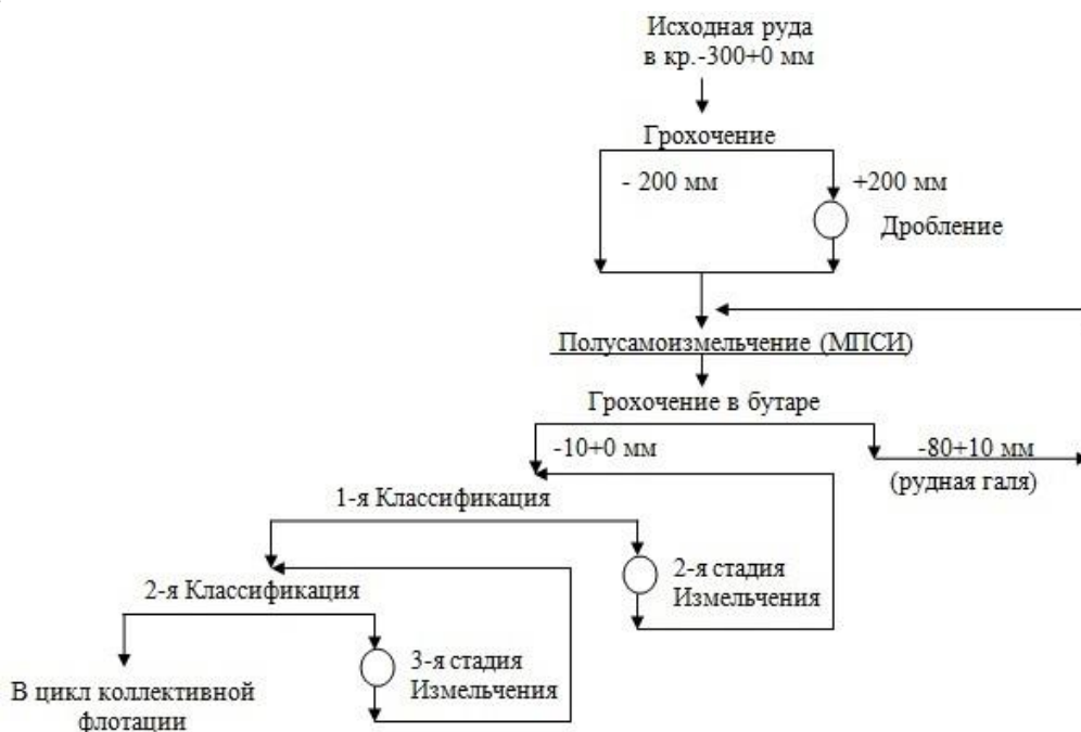
Рисунок 1 – Схема рудоподготовки 2 пускового комплекса Талнахской обогатительной фабрики
