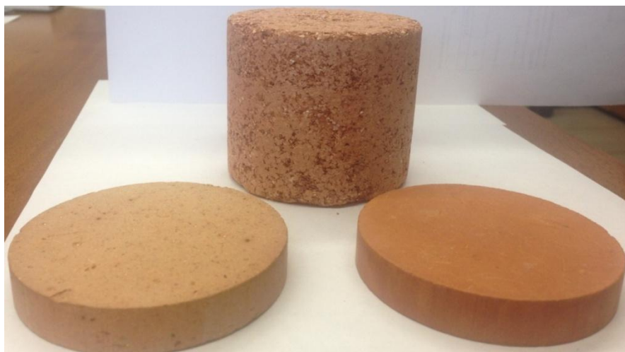
Рис. 6 Внешний вид керамики с добавками вспученного вермикулита в разном соотношении в сравнении с контрольным образцом
