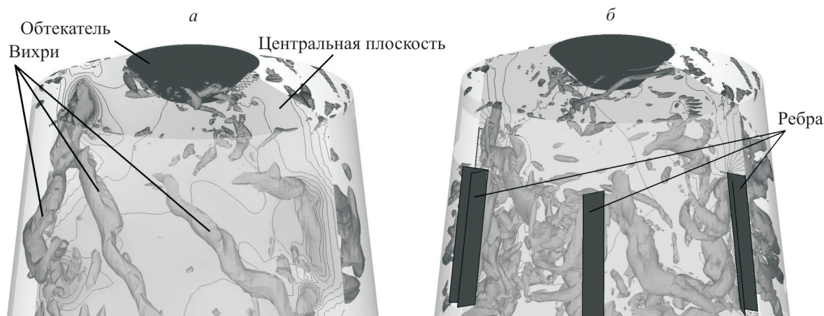
Рис. 7. Течение в отсасывающей трубе ( q/q_{\text{опт}} = 46\% ): а) без ребер; б) при наличии ребер. В центральной плоскости показаны изолинии давления, вихри показаны с помощью изоповерхности \lambda_2 -критерия
