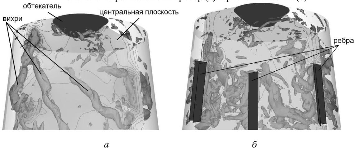
Рис. 7. Течение в отсасывающей трубе ( $q/q_{opt} = 46\%$ ): а) без ребер, б) при наличии ребер. В центральной плоскости показаны изолинии давления, вихри показаны с помощью изоповерхности  $\lambda_2$  – критерия
