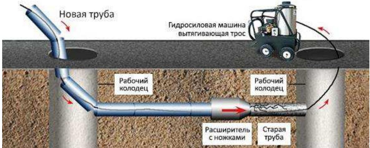
Рисунок 5 – Метод санации путем замены труб статическим разрушением
