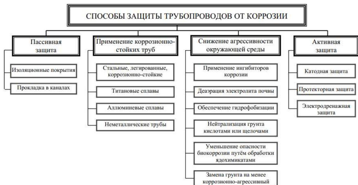
Рисунок 2 – Классификация способов защиты трубопроводов от коррозии
