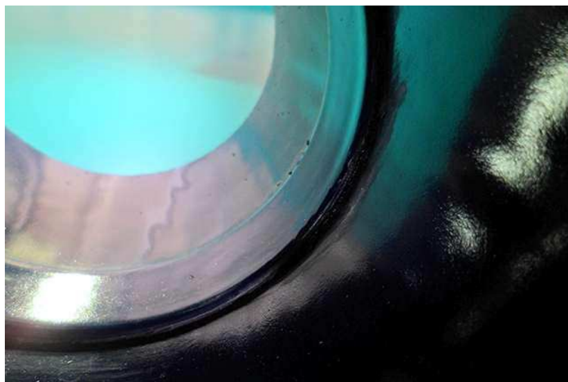
Рисунок 9 – Втулка стальная соединительная с силикатно-эмалевым покрытием
