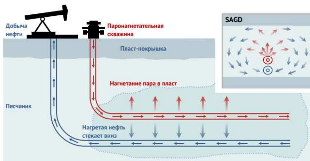
Рисунок 3 – Схема разработки месторождения методом SAGD [8]
