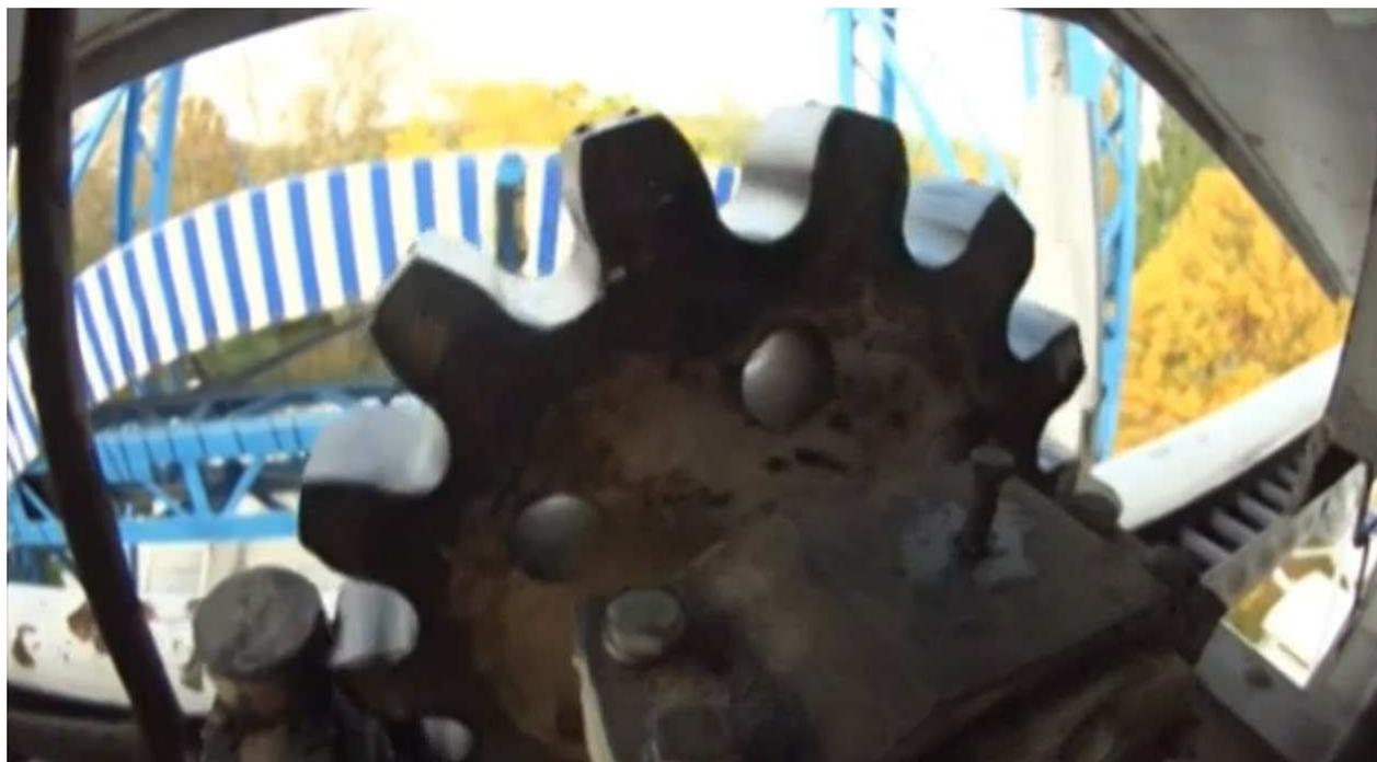
Рисунок 7 – Шестерня и венец на колесе обозрения в парке Измайлово
