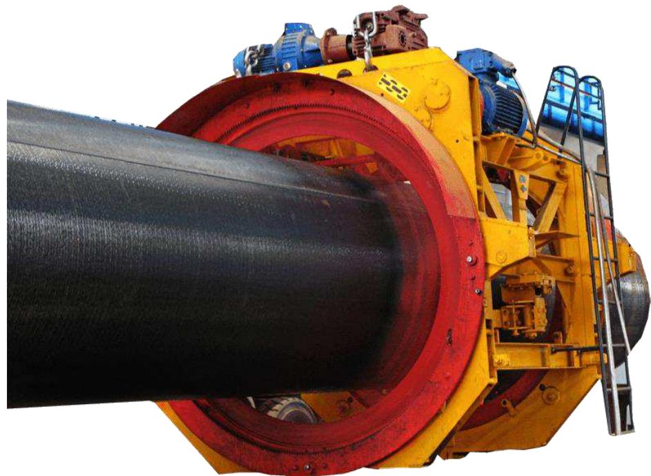
Рисунок 3.2 – Машина финишной очистки ОМ-Ф
