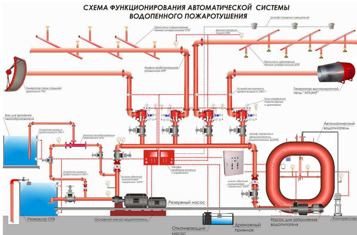
Рисунок 9.5 – Автоматическая система пенного пожаротушения.
