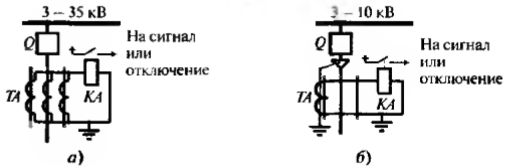
Рисунок 10.3 – Схемы токовой защиты нулевой последовательности от ОЗЗ: а) с трехтрансформаторным ФТНП; б) с кабельным ТТНП
