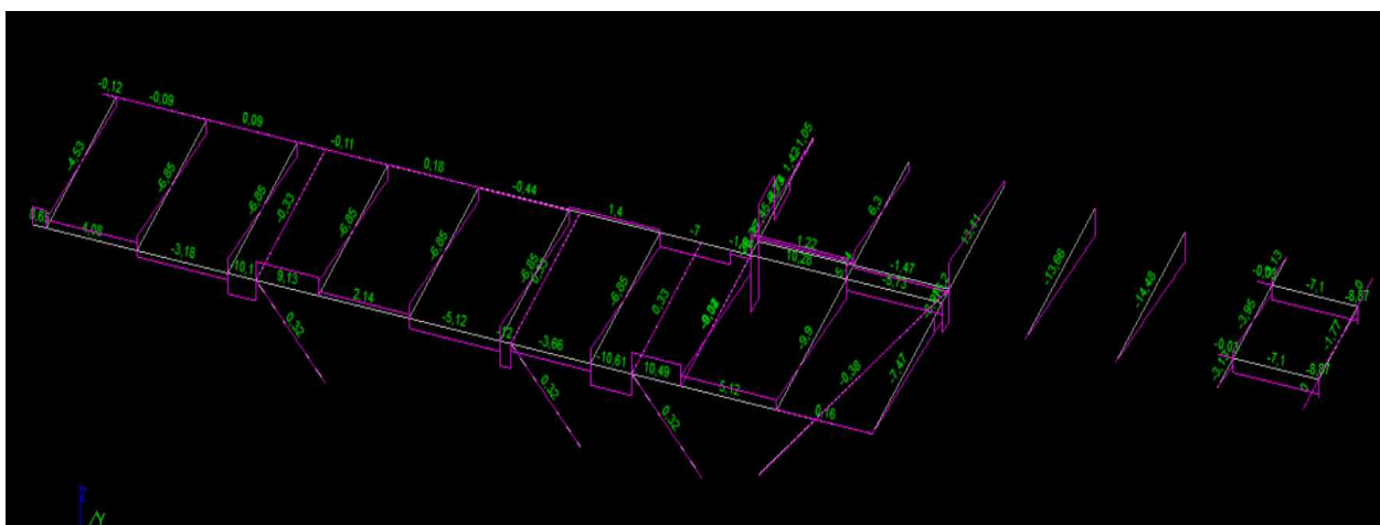
Рисунок 2.8 – Эпюры поперечных сил в стальных элементах перекрытия
