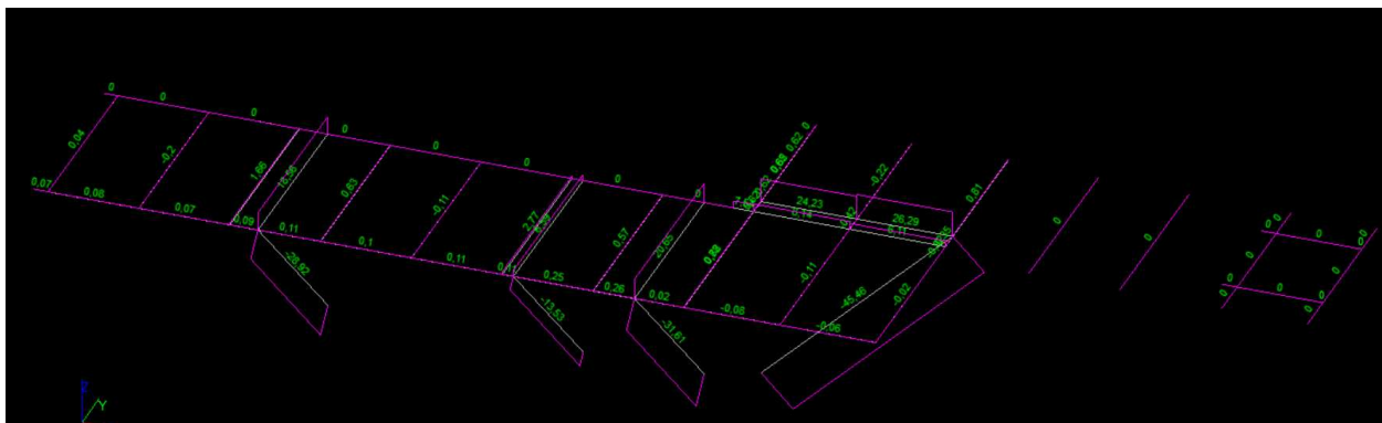
Рисунок 2.6 – Эпюры продольных сил в стальных элементах перекрытия
