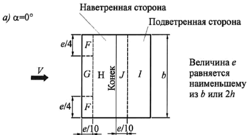
Рисунок 3.5 – Распределение ветровой нагрузки
