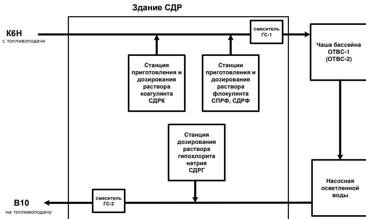
Рисунок 9 – Принципиальная схема обработки воды топливоподачи
