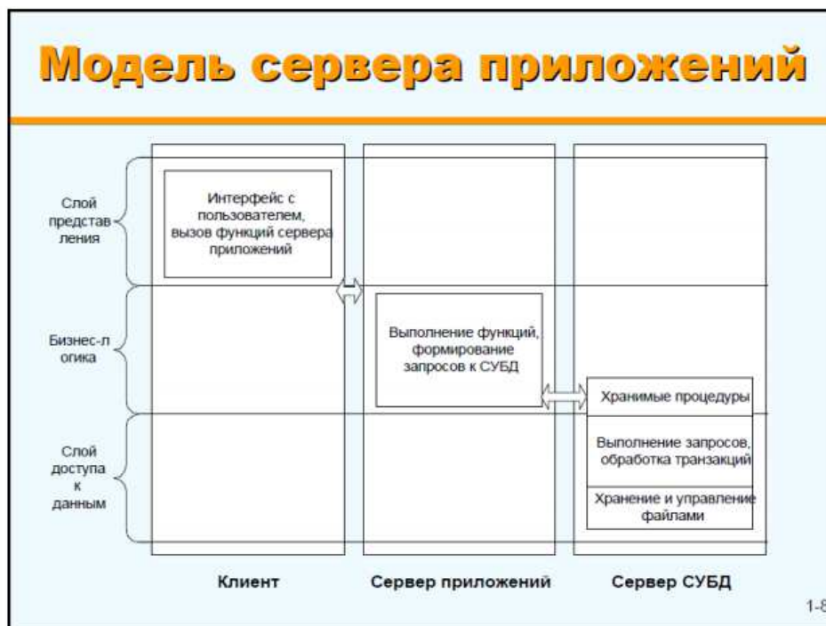
Рисунок 9 – Модель трехуровневой клиент-серверной архитектуры
