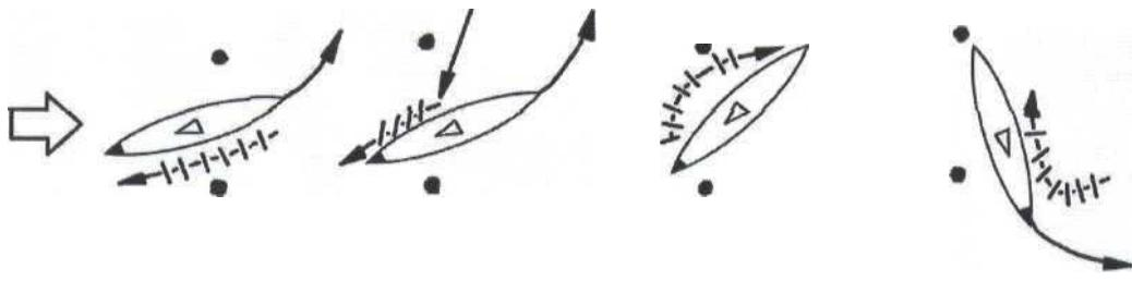
Рисунок 15 – Вариант прохождения кормовых ворот со столкновением носа в створе ворот
