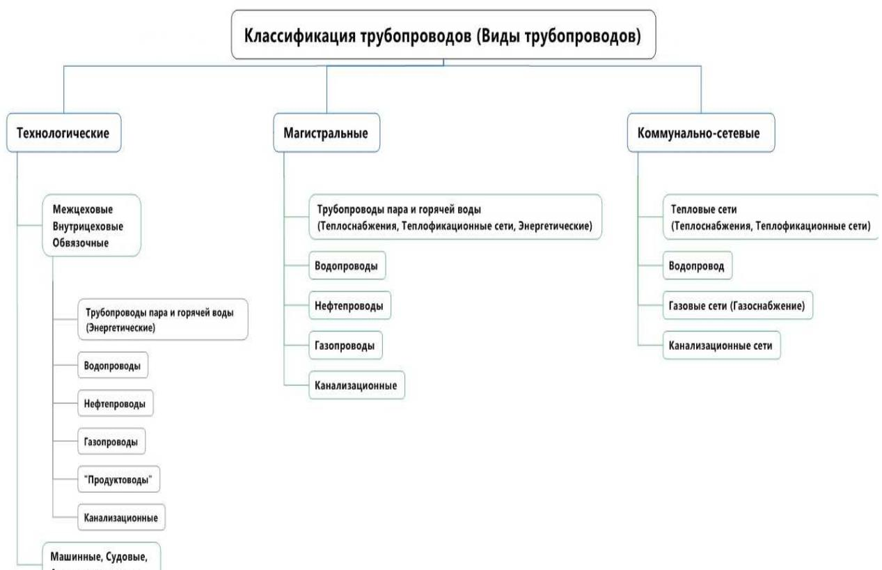
Рисунок 1 – Классификация трубопроводов
