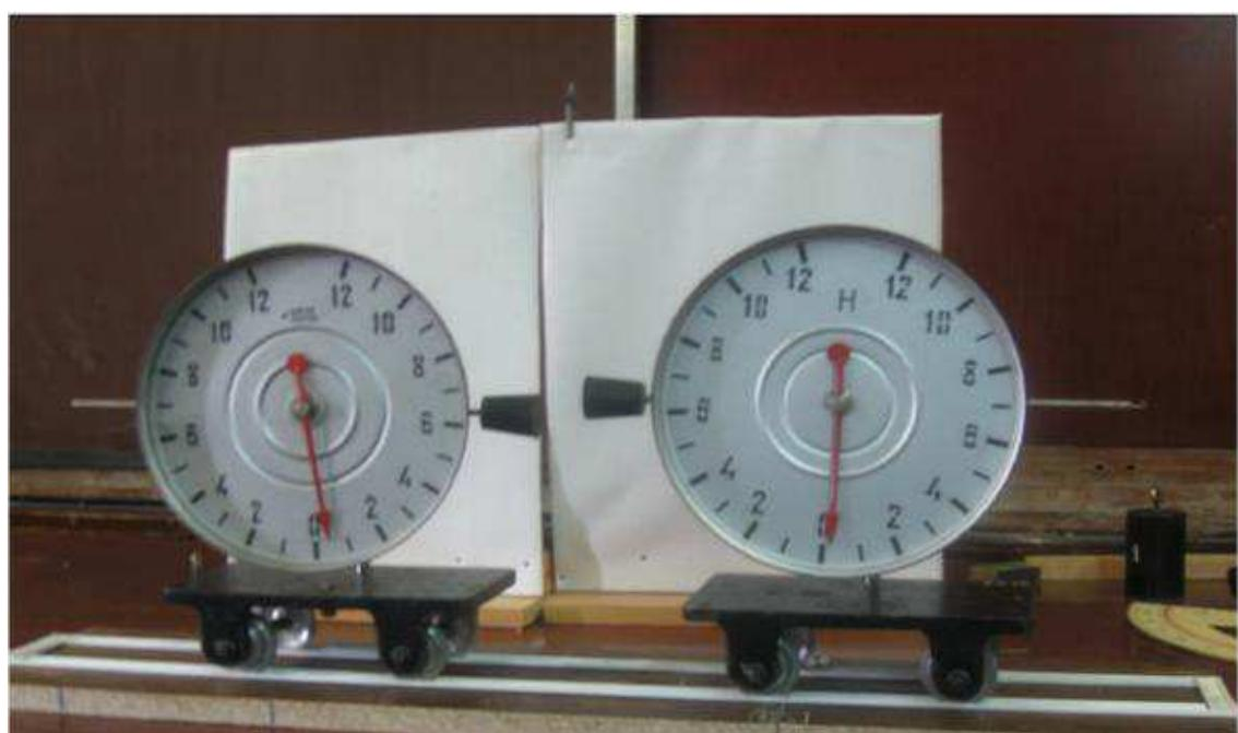
Рисунок 37 – Лабораторная работа № 2 «Третий закон Ньютона»
