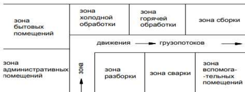
Рисунок 5.1 - Технологическая схема ремонтной базы предприятия с криволинейной зоной движения грузопотоков
