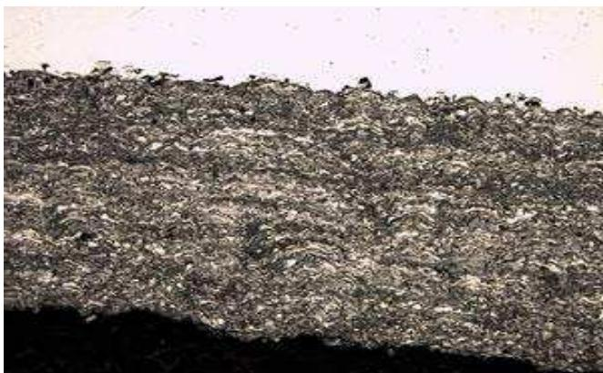
Рисунок 7.7 – Микроструктура поверхности лезвия ковша после напыления.
