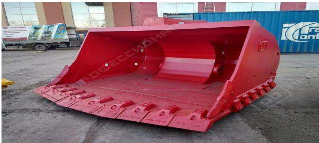
Рисунок 7.4 Ковш ПДН с режущими накладными зубьями
