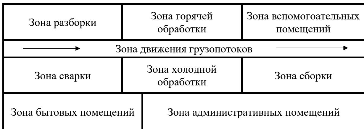
Рисунок 5.1 – Технологическая схема ремонтной базы
