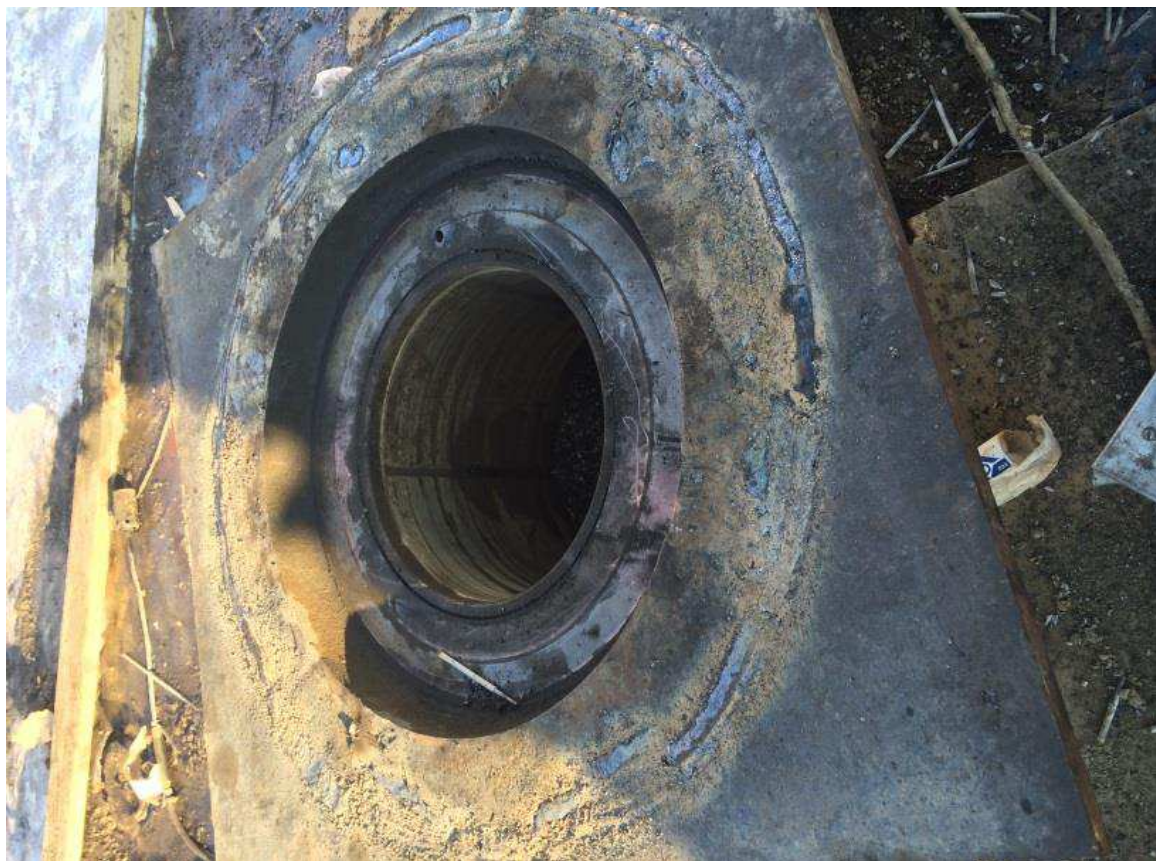
Рисунок 3.5 – Восстановленная база ходовой телеги. Вид сверху
