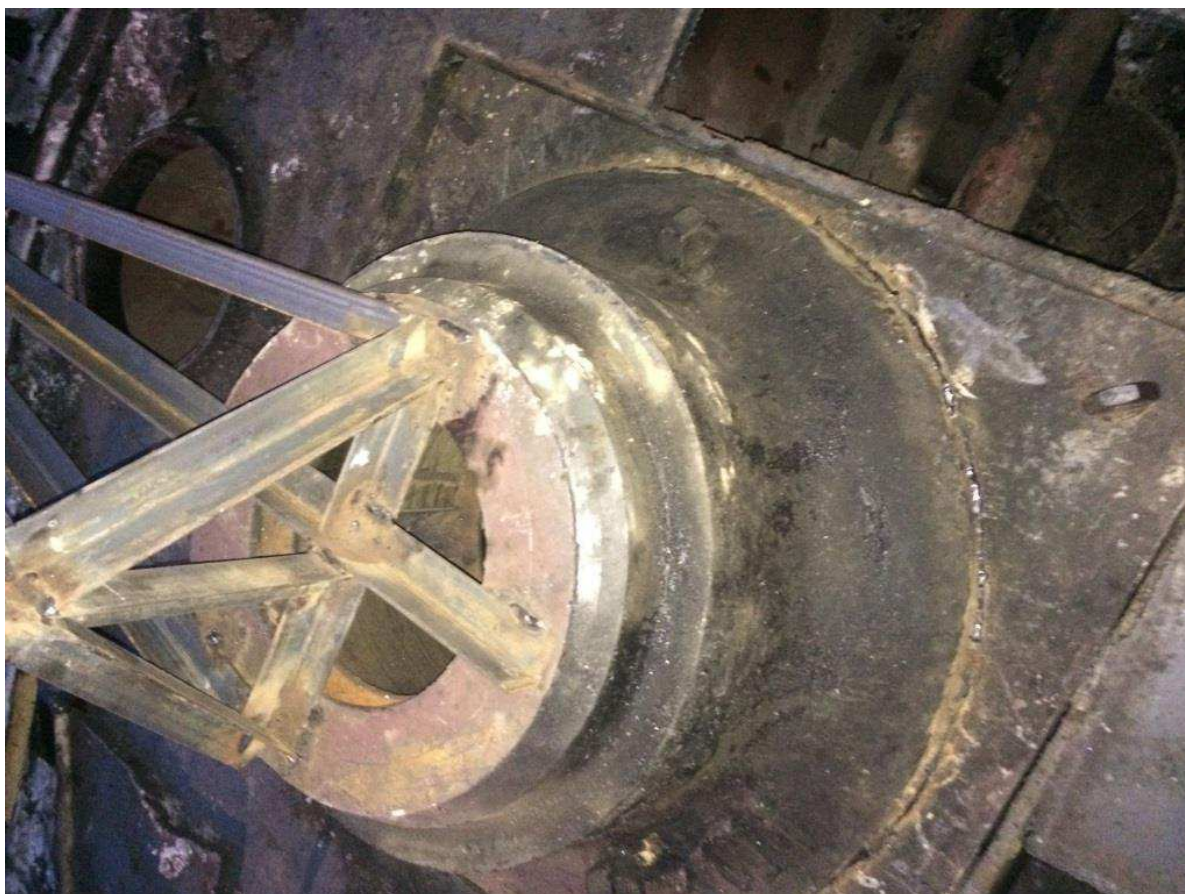
Рисунок 3.6 - Восстановленная база ходовой телеги. Вид снизу
