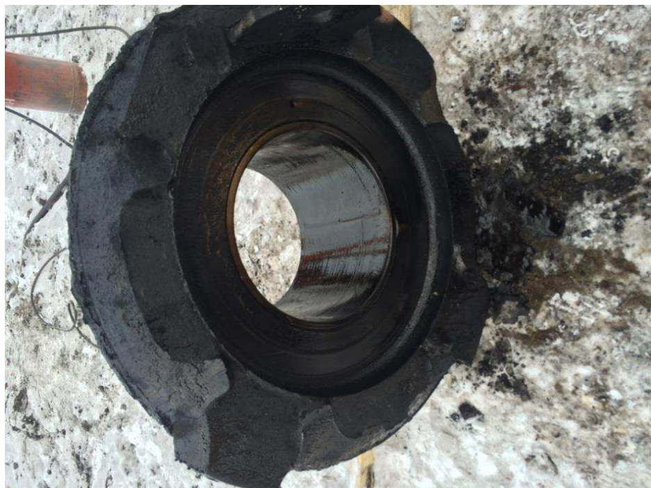
Рисунок 3.2 – Оторванный стакан от центральной цапфы
