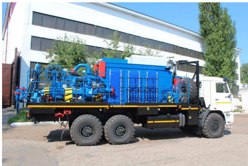
Рисунок 6 – Передвижная насосная установка (ПНУ)
